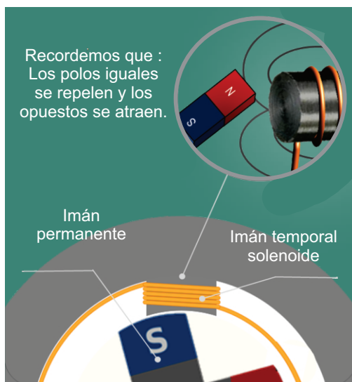
Movimiento del campo magnético a través de un conductor estático.
