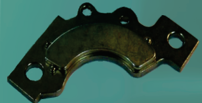
Imán perteneciente a un disco rígido de una PC.
