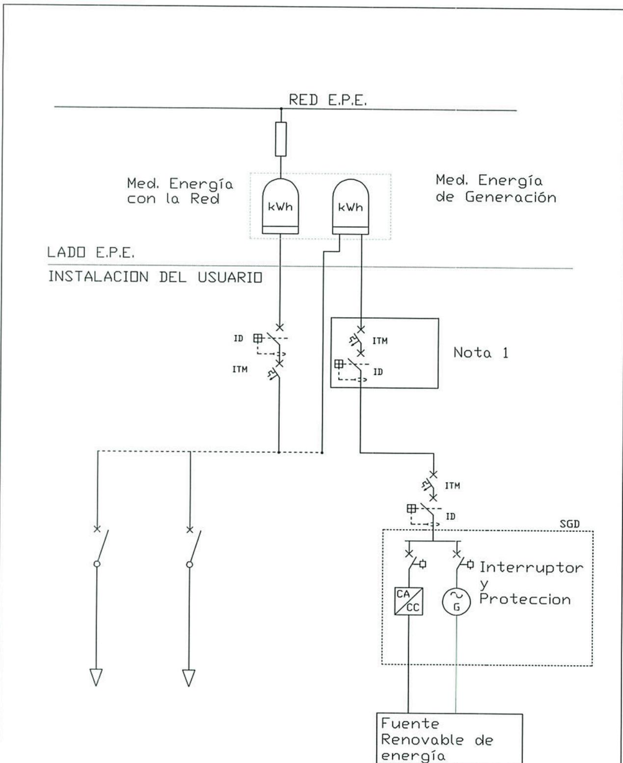
Nota 1: Es de cumplimiento si la distancia entre el medidor y la protección de SGD (50/15) es mayor a 2mts. Debiendo estar instalada la protección de Nota 1 no más de los 2mts. del medidor
